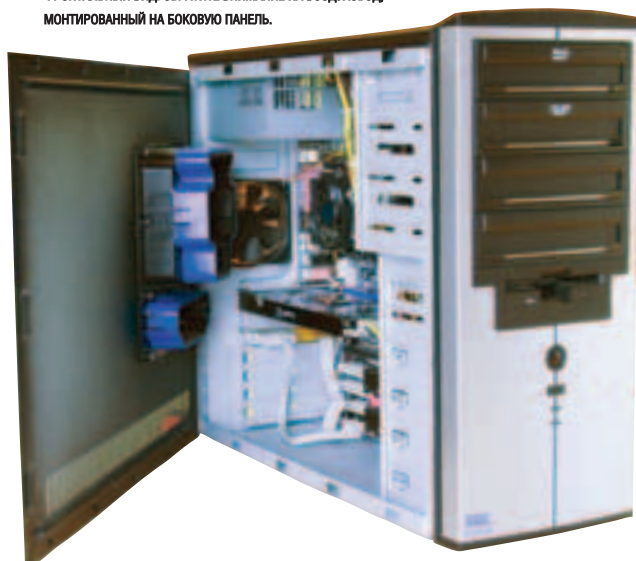
ФРОНТАЛЬНЫЙ ВИД. ОБРАТИТЕ ВНИМАНИЕ НА ВОЗДУХОВОД, МОНТИРОВАННЫЙ НА БОКОВУЮ ПАНЕЛЬ.
