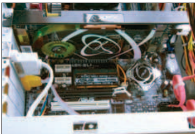
ВИДЕОКАРТА XFX GEFORCE 7800GT И ПЛАТА ПЕРЕКЛЮЧЕНИЯ РЕЖИМА SLI. ПРИ ВКЛЮЧЕННОЙ СИСТЕМЕ ЛОГОТИП НА БОКОВОЙ ПАНЕЛИ ОСВЕЩАЕТСЯ ЗЕЛЕНОЙ ДИОДНОЙ ПОДСВЕТКОЙ.
